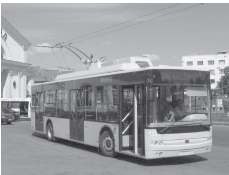
Машина оснащена кондиционером, воздушной подушкой и пандусом для людей с инвалидностью
